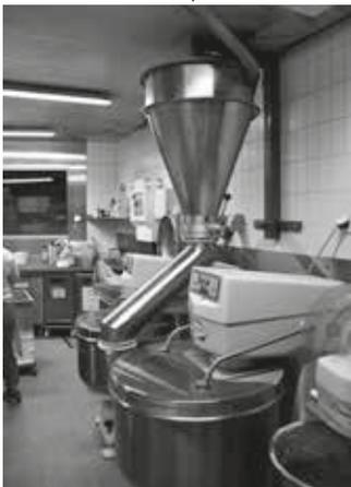
Das Mehl kommt über Rohre direkt in die Dosieranlage.
