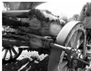
Die mechanische Bremsvorrichtung mit Handkurbel.
