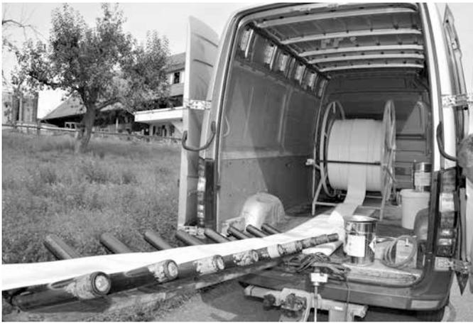
Der Kastenwagen mit dem aufgewickelten Liner
