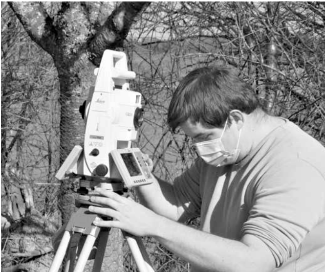
Das Tachymeter wird mittels einer Libelle ins Lot gebracht
