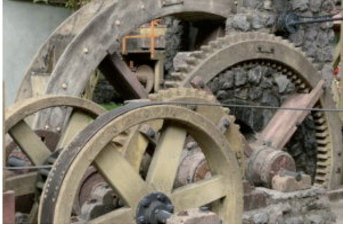
Beispiel eines Antriebswerks aus einer mittelalterlichen Mühle
