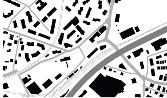
Ansatz 6 arbeitet mit einem Längsbau, welcher einen Platz gegen das Zentrum schafft. Im nordöstlichen Bereich des Areals wird ein hoher Baukörper ca. in gleicher Höhe wie der Landiturm (35 m) vorgeschlagen. Dieser schliesst die Situation am Kriseel ab und erscheint ortsbaulich verträglich.
